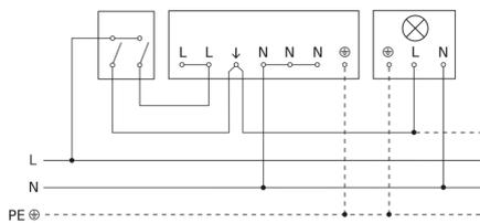
Schaltplan Anschluss über einen Wechselschalter für Dauerlicht- und Automatik-Betrieb
